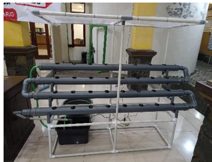
Gambar 2. Hidroponik Deep Flow Technique (DFT) (Sumber : Data Pribadi Penulis)
