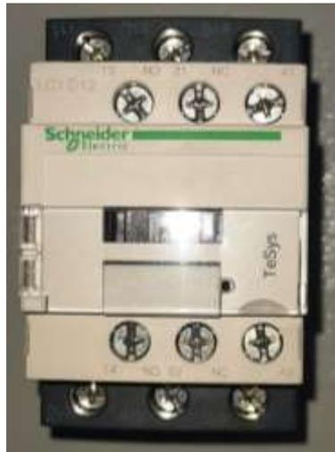
**Gambar 3 Kontaktor magnetik**
