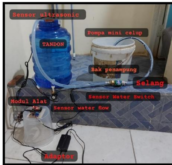
Gambar 12. Hasil Rangkaian Keseluruhan Alat
