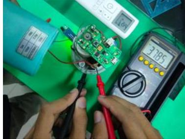
**Gambar 13. Pengetesan Modul Relay**
