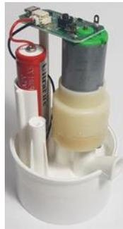
**Gambar 4. Bagian Dalam Pompa Air Listrik**
