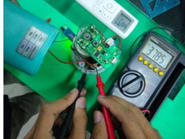
Gambar 13. Pengetesan Modul Relay
