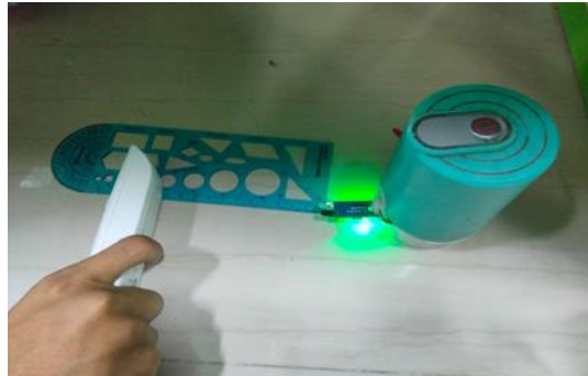
Gambar 12. Pengetesan Jarak Pada Modul Sensor
