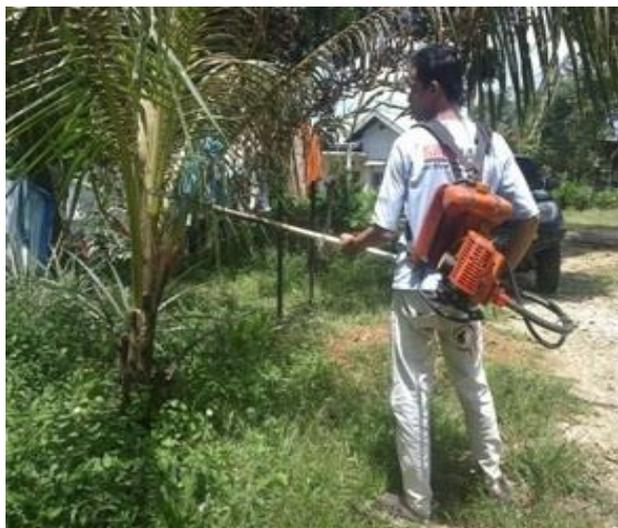
Gambar 10. Uji Coba Alat Panen Sawit Mekanik
