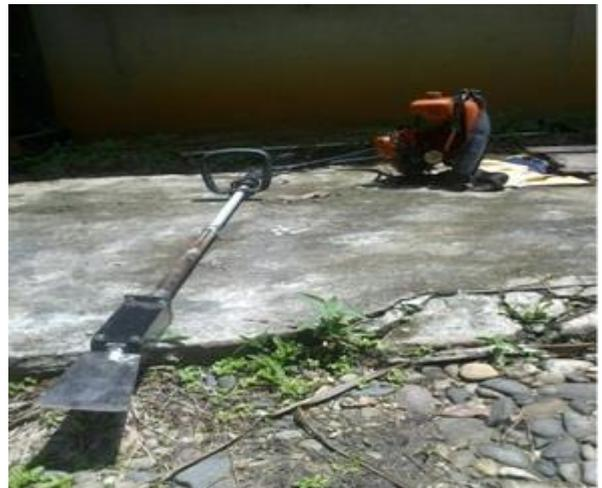
Gambar 9. Alat Panen Sawit Mekanik Terpasang Pada Mesin Pemotong Rumput
