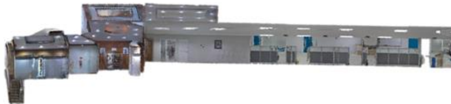
Gambar 5. Tampilan model hasil pengukuran Handheld SLAM LiDAR .
