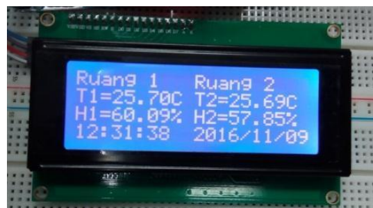
Gambar 3. Tampilan hasil pembacaan sensor pada LCD 20x4
