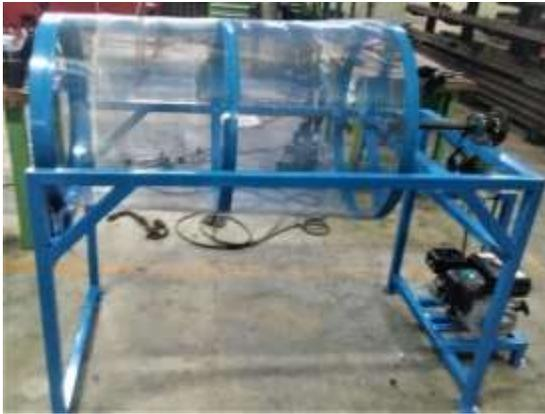
Gambar 3. Mesin Pengayak Pasir Tipe Rotary
