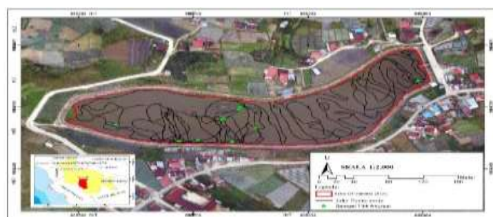
Gambar 6. Hasil Data Pengukuran Survei Batimetri.
