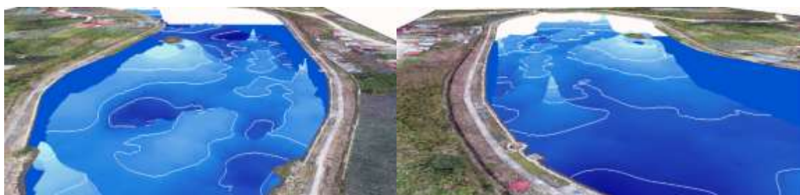
Gambar 4&5. Visualisasi 3D Batimetri Embung Sungai Nanam (Tampak sisi barat dan timur).
