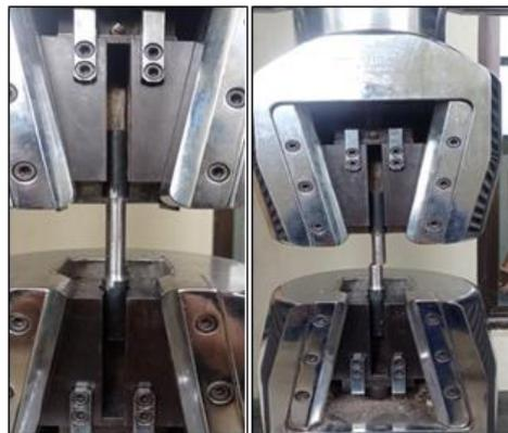
**Gambar 6. Spesimen PKO 100%**
