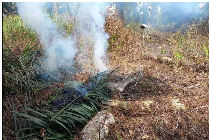
Gambar 9. Pengujian Pengaruh Jarak pada Sensor MQ4 dan DHT11
